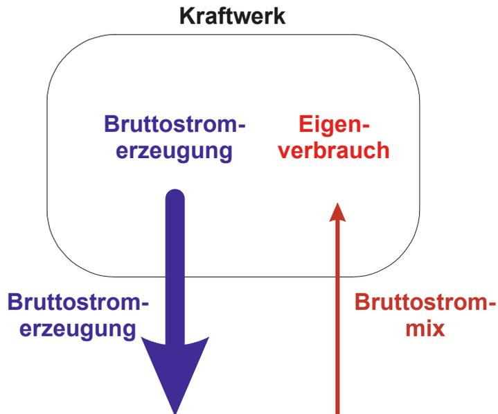
Die **Bruttostromerzeugung** beinhaltet auch den Eigenverbrauch der Kraftwerke, der direkt im Kraftwerk verbraucht wird und physikalisch gar nicht in das öffentliche Stromnetz eingespeist wird. Auf der Verbrauchsseite wird der Eigenverbrauch der Kraftwerke dem Bruttostromverbrauch zugerechnet, damit die Bilanz wieder stimmt. Nach dieser Konvention wird z.B. eine Kohlemühle im Braunkohlekraftwerk mit dem Bruttostrommix und damit mit ca. 55% erneuerbaren Energien betrieben.
