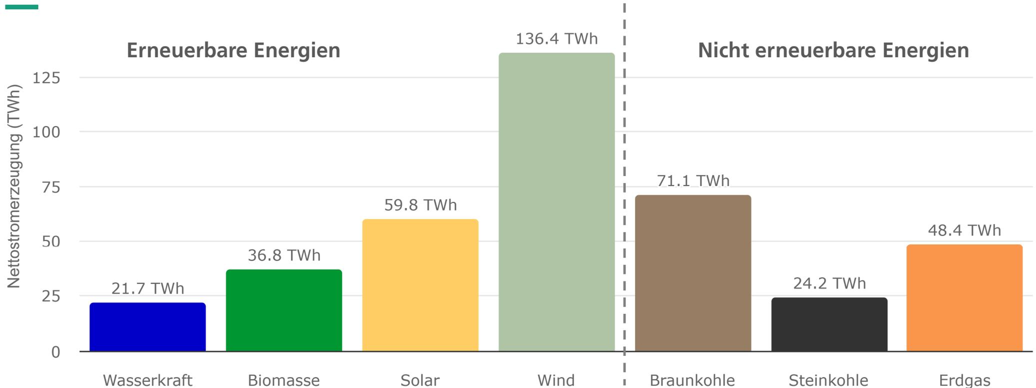
Die Grafik zeigt die Nettostromerzeugung aus Kraftwerken zur öffentlichen Stromversorgung. Das ist der Strommix, der tatsächlich aus der Steckdose kommt. Der Selbstverbrauch von Solarstrom und die Erzeugung aus Kraftwerken von „Betrieben im verarbeitenden Gewerbe sowie im Bergbau und in der Gewinnung von Steinen und Erden“, d.h. die industrielle Erzeugung für den Eigenverbrauch, ist bei dieser Darstellung nicht berücksichtigt.
