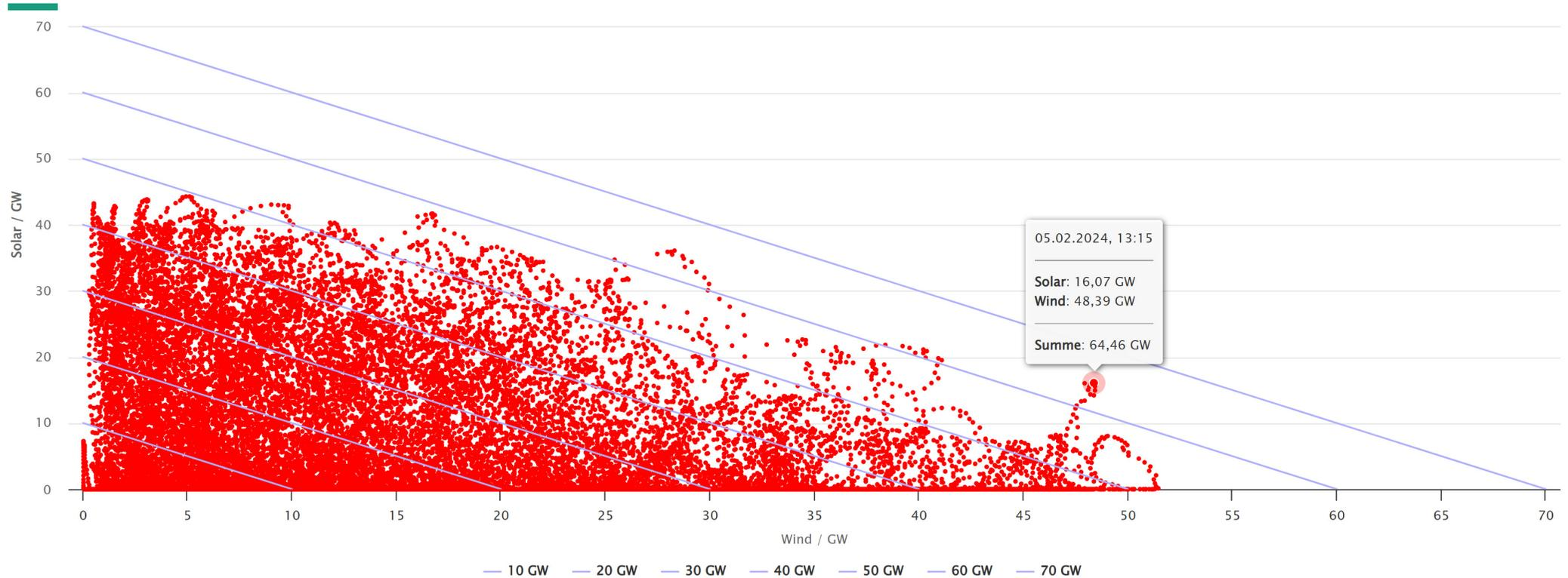
Die Grafik zeigt ca. 35 Tausend Viertelstundenwerte der Solarleistung über der Windleistung im Jahr 2024. Die maximale Summe von Solar- und Windleistung betrug 64,5 GW am 05.02.2024. Davon entfielen 16,1 GW auf Solar und 48,4 GW auf Wind. Das sind nur 38% der installierten Leistung von 170 GW (98 GW Solar und 72 GW Wind).
